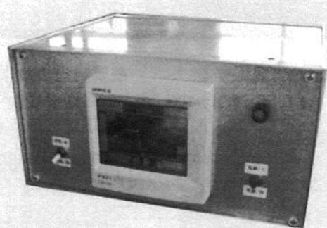
写真6 加圧力モニタ装置
