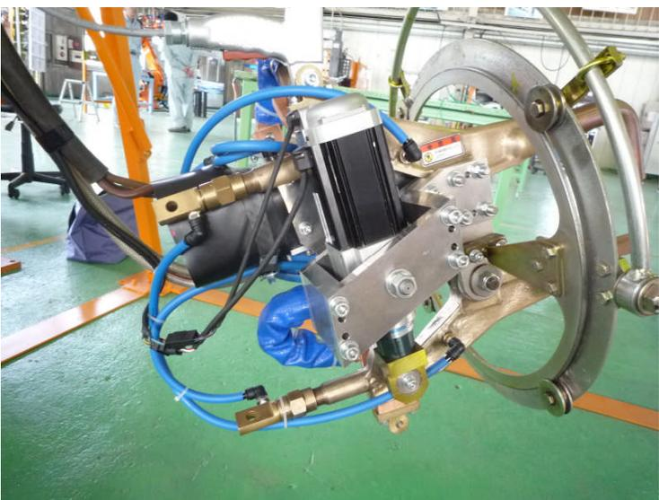
2次ケーブル式ガンにART-HIKARI製MFTトランスと専用溶接電源、サーボモーターを取り付けました。
