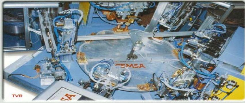
自動化セル(自動ワーク供給装置):
